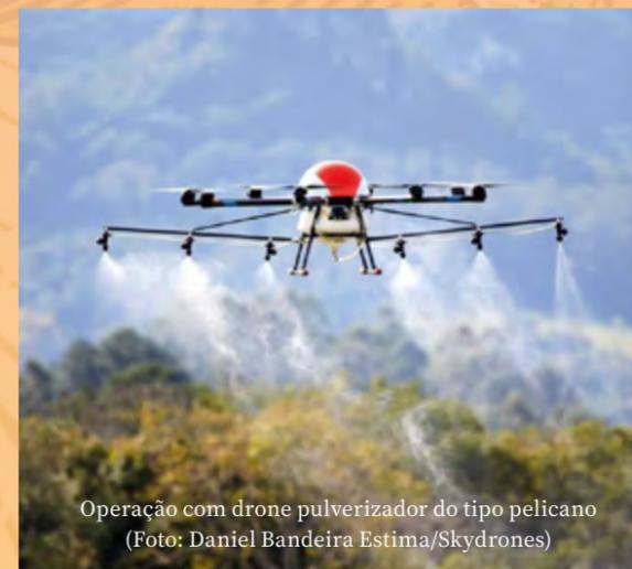
Operação com drone pulverizador do tipo pelicano
